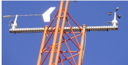
Abbildung 14 – Anemometer (rechts). Quelle: Farmatin, "Eureka Airport anemometer", <https://commons.wikimedia.org>, CC-BY-SA
