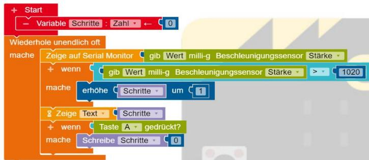
Abbildung 24 - Mögliche Realisierung des Programms zum Schrittzähler. Quelle: Eigene Darstellung, CC-BY-SA
