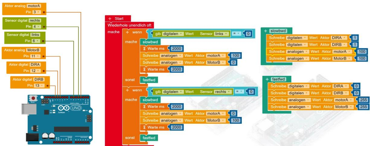
Abbildung 13 - Eine mögliche Realisierung des Programms für den Arduino mit Open Roberta. Quelle: Eigene Darstellung, CC-BY-SA
